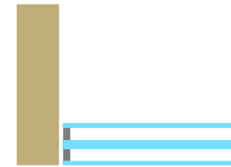
Querwandanschluss mit Stufenglas EI30
